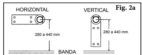
**Sugerencia:** Para bandas muy rápidas (más de 3 m por segundo) resulta muy útil levantar el extremo trasero del paralelogramo 10 mm y para bandas muy rápidas y anchos de más de 1200 mm, 10 mm adicionales para un máximo de 20 mm. El área de superficie en la parte trasera del deflector en V tiene más área de fricción y por ello, con la velocidad de la banda, la punta o sección delantera de la V tiende a perder contacto con la banda.
