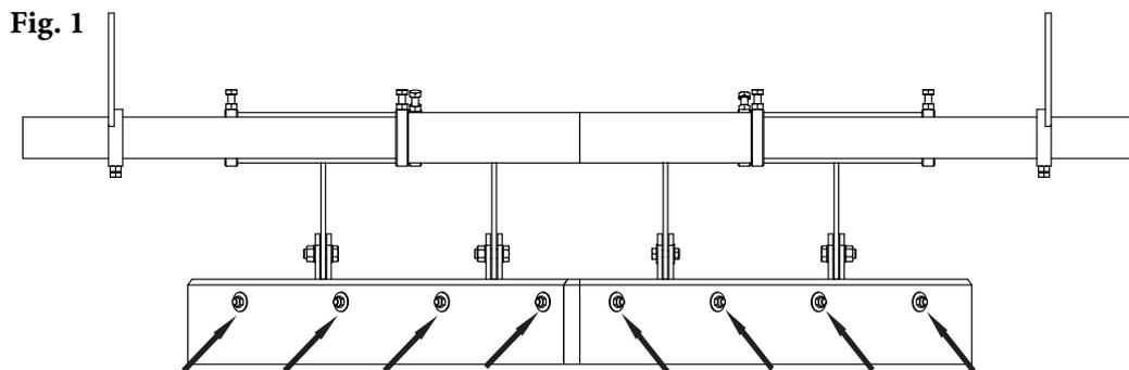
3. Ejecute pruebas e inspeccione. Ponga a funcionar la banda y revise si el deflector en V de doble eje funciona sin problemas y tiene una acción de limpieza eficaz. Si ocurre alguna vibración, gire el ajustador para subir un poco la punta.
